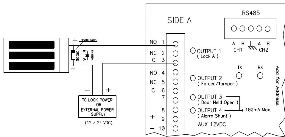
For magnetiske låse, kan relæet konfigureres som normalt energized for fejsikker operation. Hvis strømmen forsvinder, (*AC og batteri*) eller hvis brand-inputtet udløses, vil spændingen til den magnetiske lås blive fjernet og døren åbnet.
