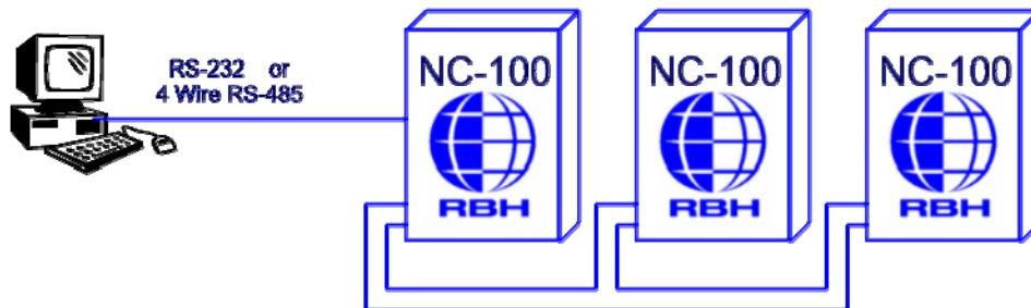
Terminalerne forbindes med hinanden i et high-speed fejltolerant ringnetværk. Fejltolerance betyder, at systemet er immunt overfor fejl et enkelt sted i ringen og vil fortsætte med at operere med en kortslutning eller et brud i en enkel kabelsektion. Fejltilstanden rapporteres til PC'en.
